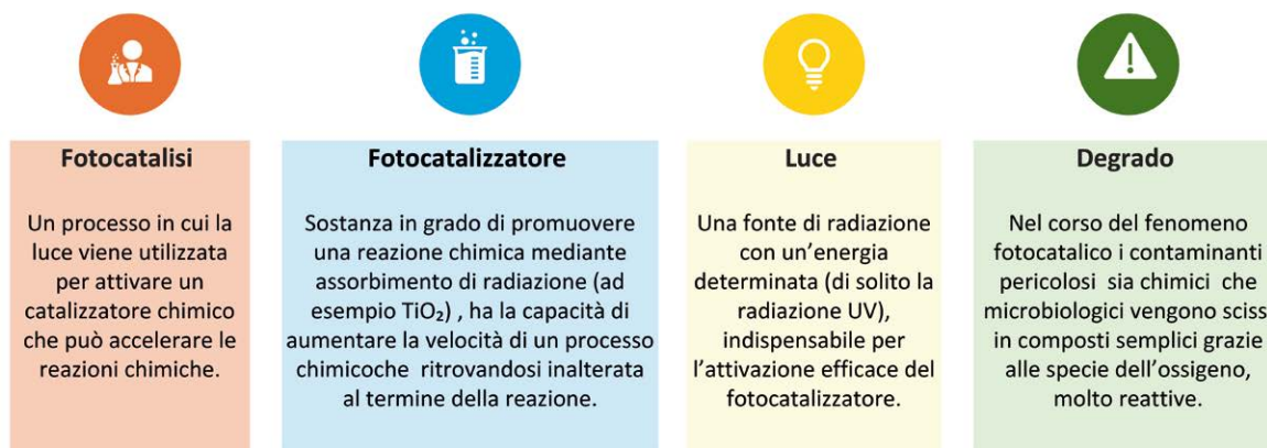
▲ Figura 2 - Fattori che determinano l'efficacia del processo di fotocatalisi
